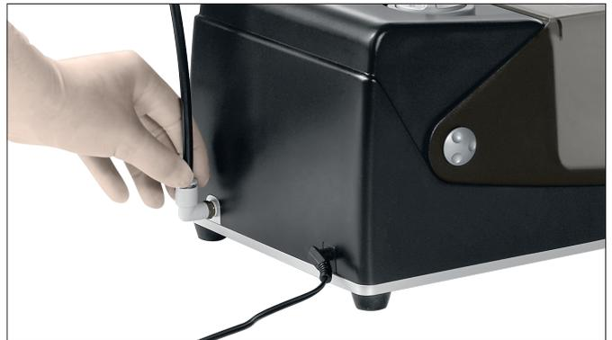
Den Öltank mit Synthes-Wartungsöl, 40 ml, für EPD und APD (05.001.095) befüllen, wie im Kapitel Pflege und Wartung beschrieben.
